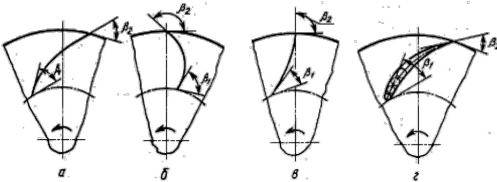
а - лопатки, загнутые назад ( $\beta_2 > 90^\circ$ ); б - лопатки, радиально оканчивающиеся ( $\beta_2 = 90^\circ$ ); в - профильная лопатка
